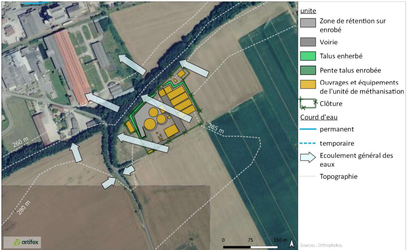
Illustration 20 : Carte d'écoulement des eaux superficielles à l'échelle locale Source : Orthophotographie IGN ; Réalisation : ARTIFEX 2022
